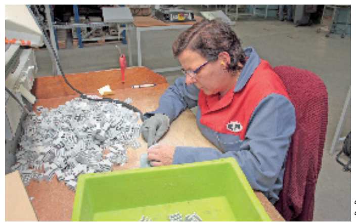
Le moulage des thermodurs impose des finitions (ébavurage) plus importantes que celui des thermoplastiques.
